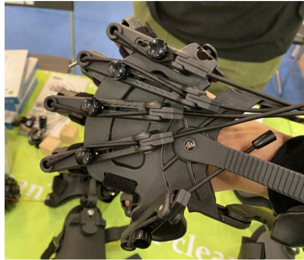
ภาพที่ 16 มือกลสำหรับฟื้นฟูกล้ามเนื้อและนิ้วมือ
