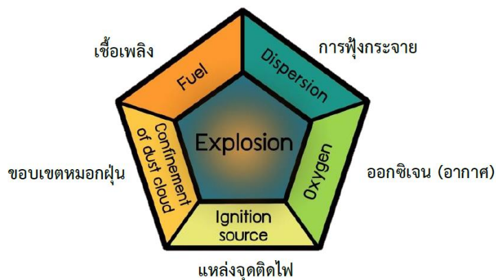
ภาพที่ 3 แสดงห้าเหลี่ยมของการระเบิดของฝุ่น
