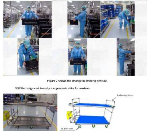
ภาพที่ 2 ท่าทางการยกของ และอุปกรณ์ช่วยยกเพื่อลดความเสี่ยงด้านการยศาสตร์
